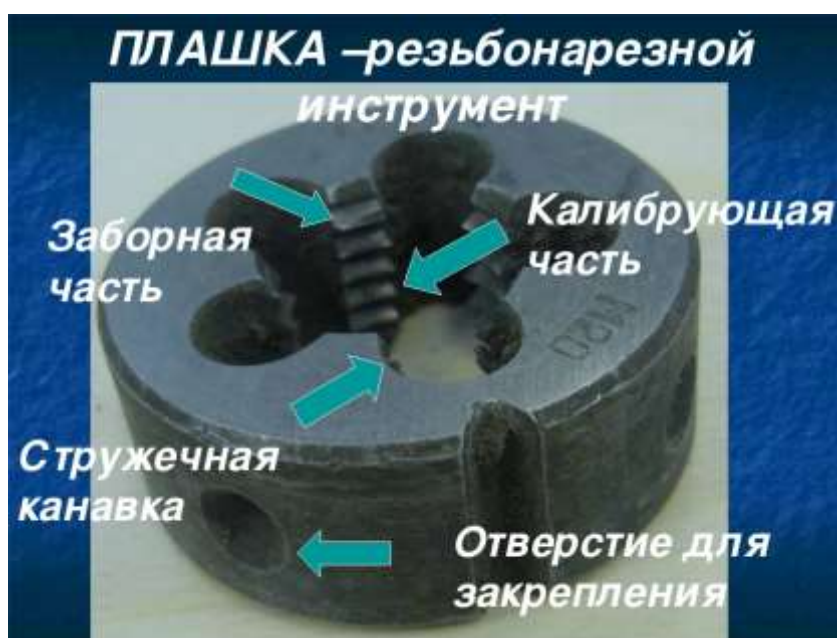
Рисунок 98 – Конструктивные элементы плашки
