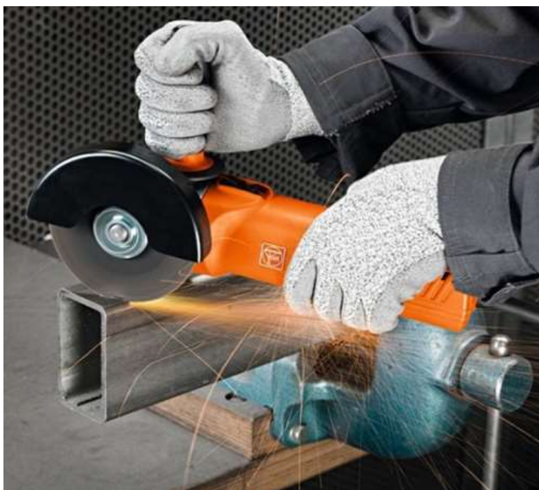
Рисунок 135 – Отрезание угловой шлифмашинкой
