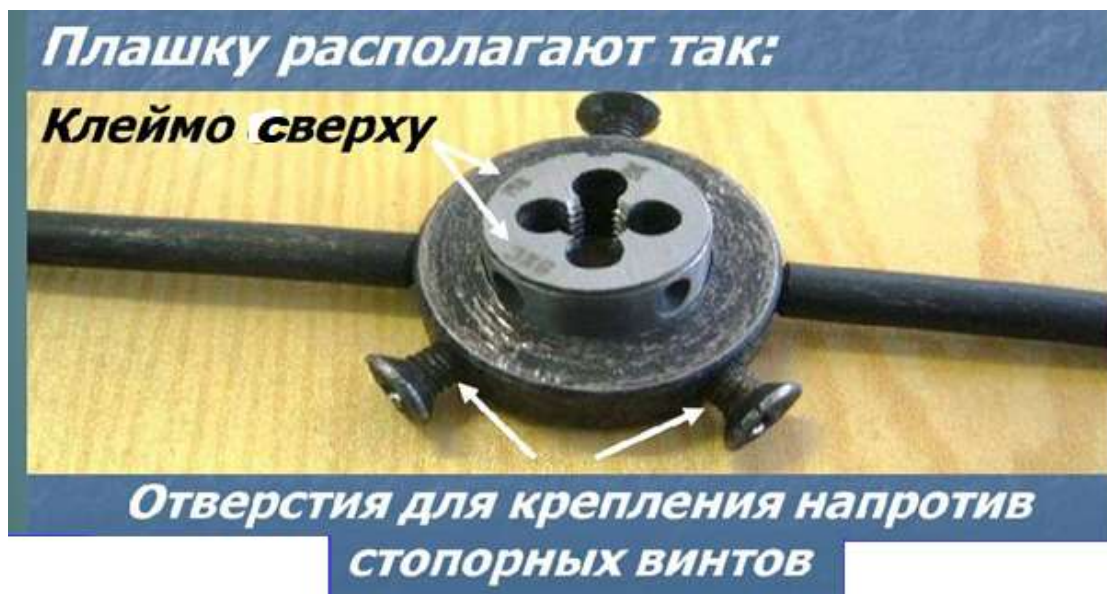
Рисунок 101 – Установка плашки в плашкодержателе
