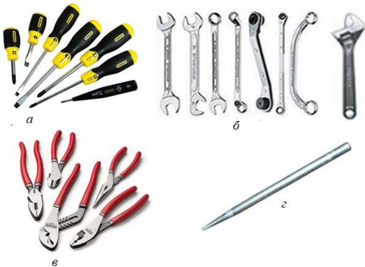
Рисунок 12 – Слесарно-сборочные инструменты: а – отвертки; б – гаечные ключи; в – плоскогубцы; г – бородак
