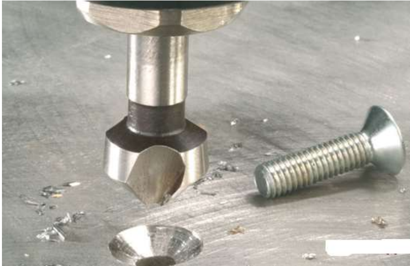
Рисунок 90 – Зенкование под потайную головку винта
