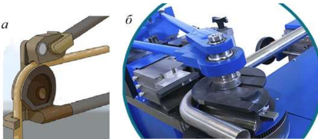
Рисунок 67 – Гибка труб без нагрева на трубогибочных станках: а – ручных; б – приводных
