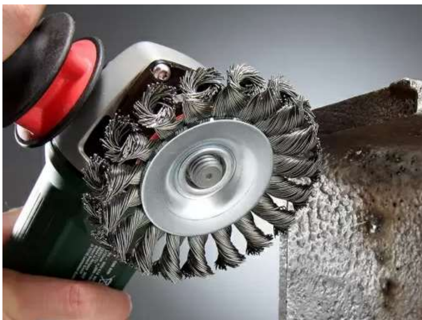
Рисунок 136 – Обработка щеточной шлифмашинкой
