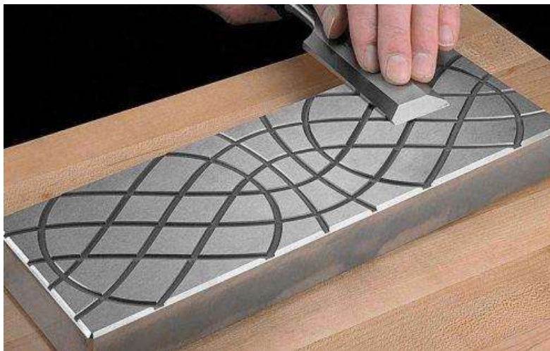
Рисунок 143 – Плоский чугунный притир
