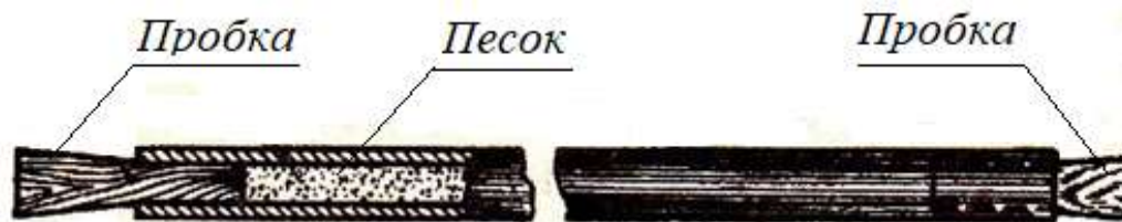
Рисунок 66 – Заполнение трубы песком
