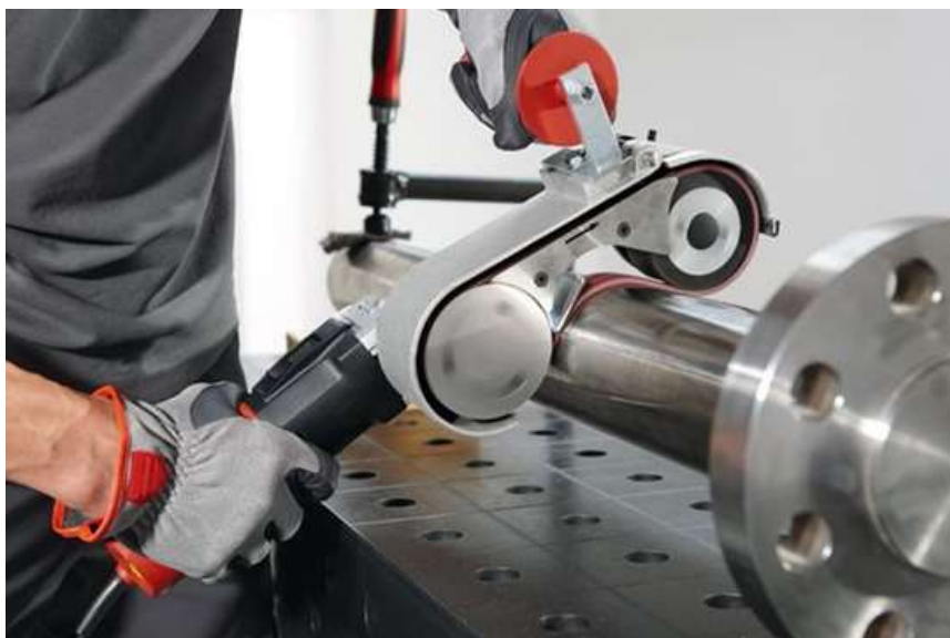
Рисунок 133 – Шлифование ленточными шлифмашинками
