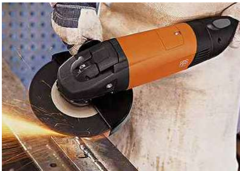
Рисунок 134 – Шлифование угловой шлифмашиной
