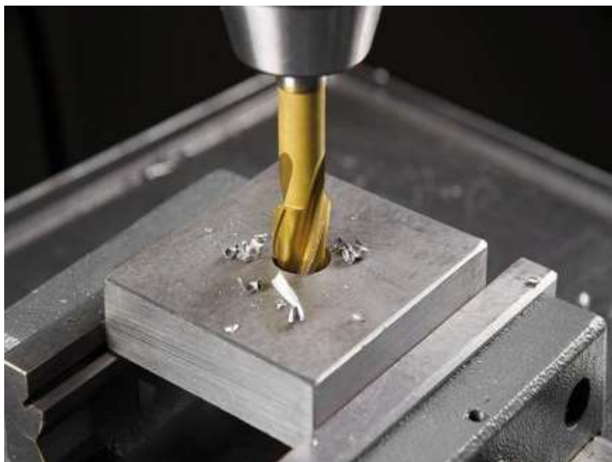
Рисунок 88 – Зенкерование отверстия на сверлильном станке
