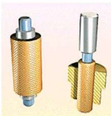
Рисунок 145 – Притиры нерегулируемые и регулируемые: 1 – гайка; 2 – коническая оправка; 3 – разрезная втулка; 4 – гайка
