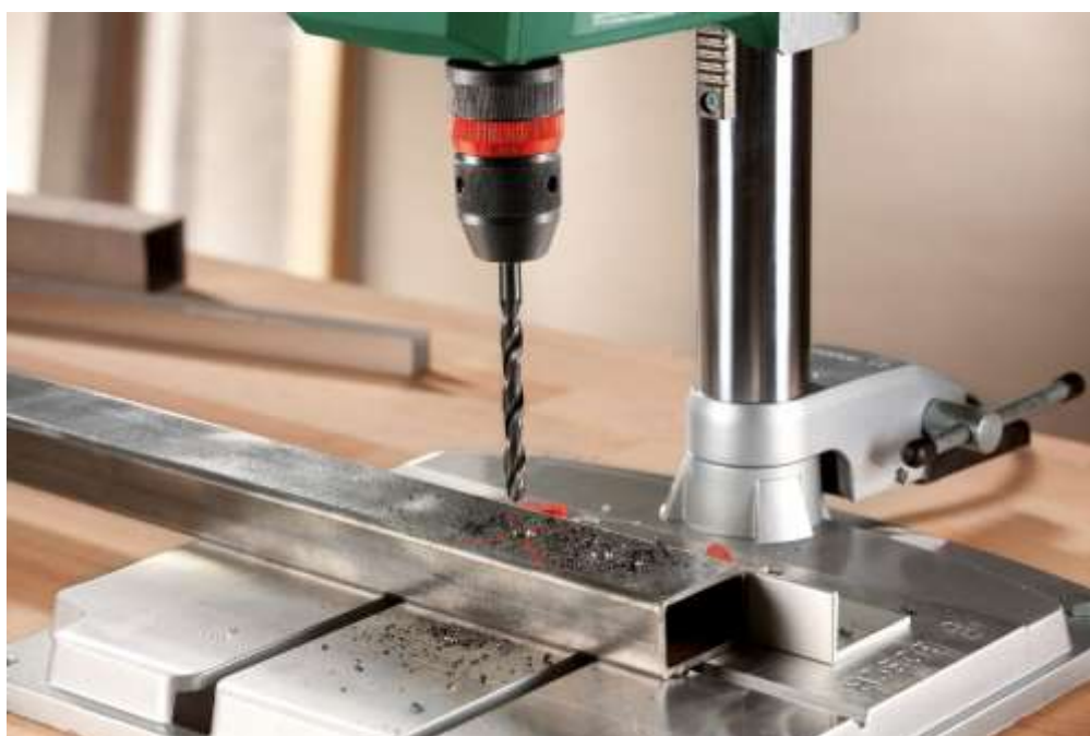
Рисунок 82 – Сверление отверстий на сверлильном станке
