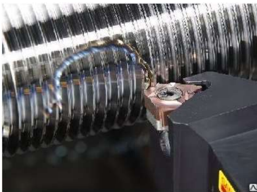
Рисунок 104 – Нарезание наружной резьбы машинным способом
