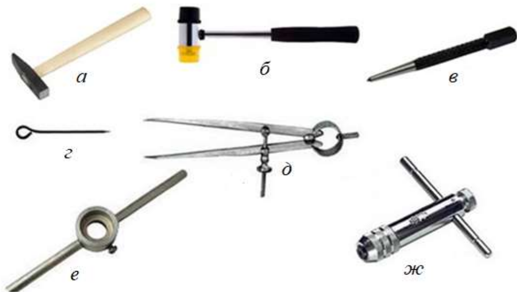
Рисунок 11 – Вспомогательные инструменты: а – слесарный молоток; б – рихтовальный молоток; в – кернер; г – чертилка; д – разметочный циркуль; е – плашкодержатель; ж – вороток для метчиков
