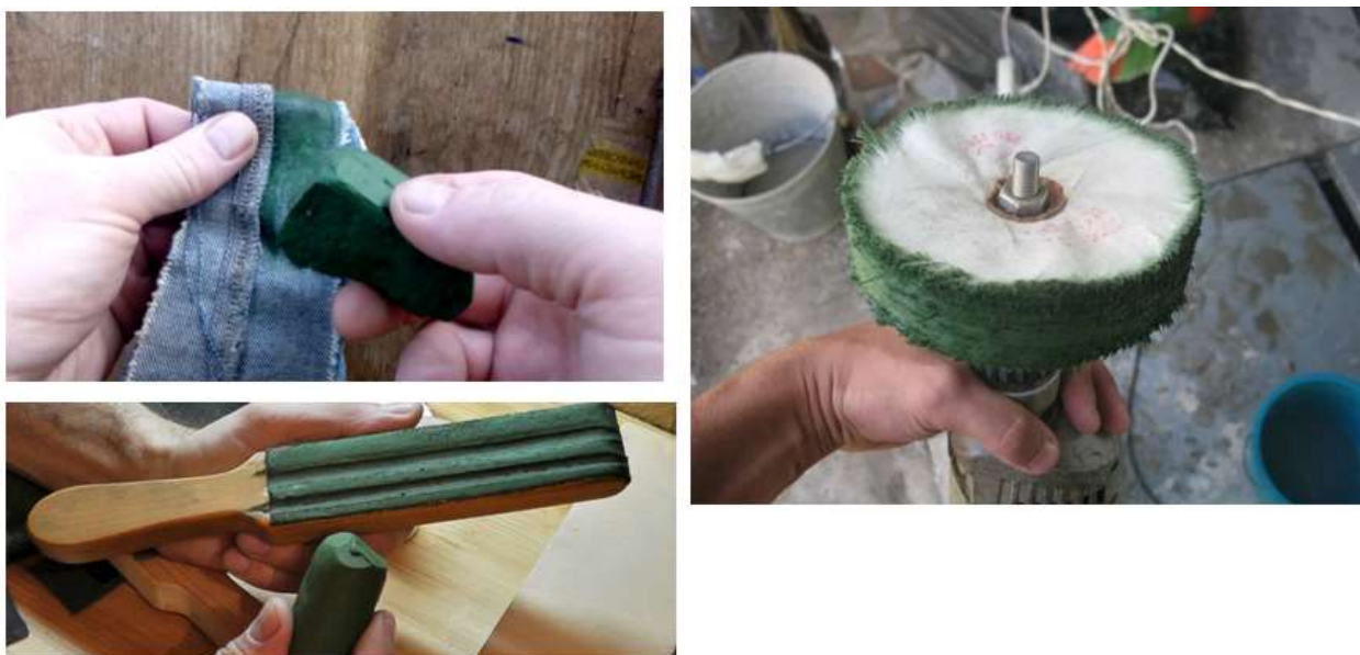
Рисунок 141 – Нанесение полировальной пасты на инструмент
