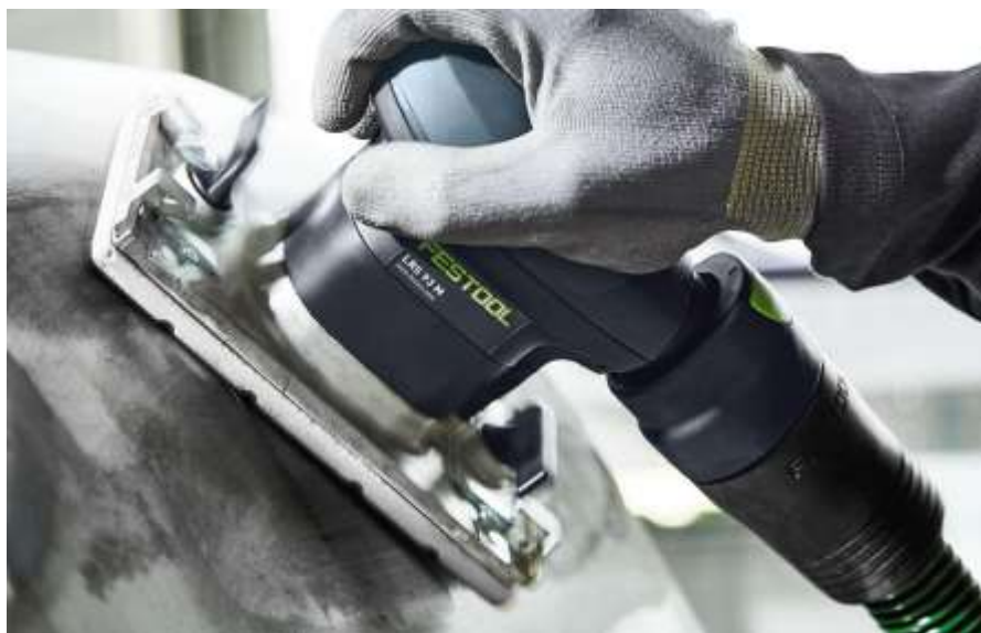
Рисунок 131 – Шлифование плоскошлифовальной машинкой
