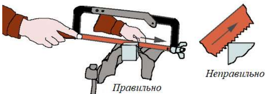
Рисунок 49 – Положение ножовки при резке
