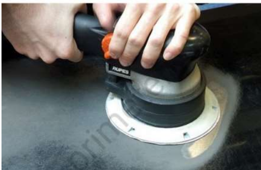
Рисунок 130 – Шлифование эксцентрикковой (орбитальной) шлифмашинкой
